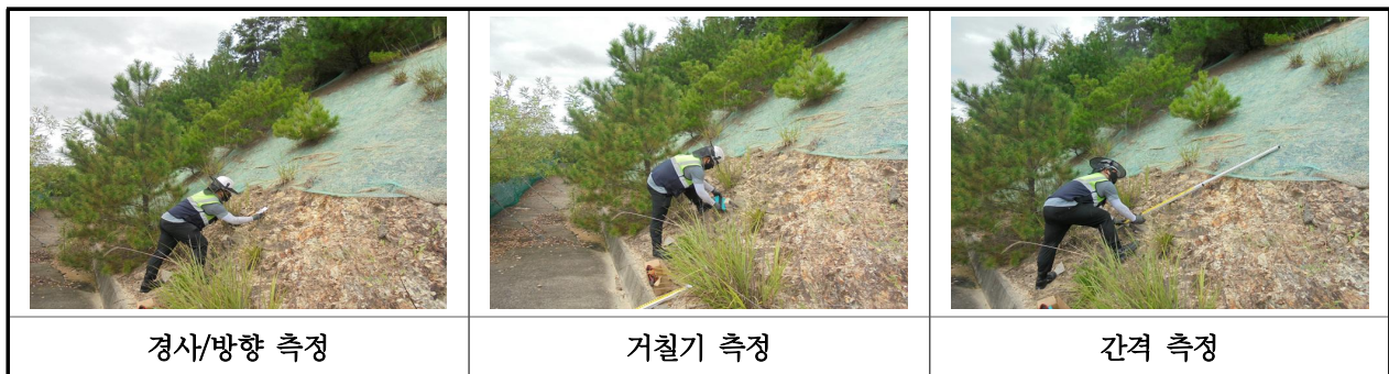
【사진 8.3.3】 불연속면 측정 현황
